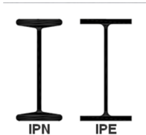
Figure II.4 : poutrelle en I
