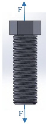
Figure III.2 : l'effort appliqué sur la vis
