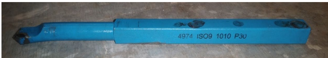
Figure 9: Outil à aléser section ronde pour finition de l'alésage
