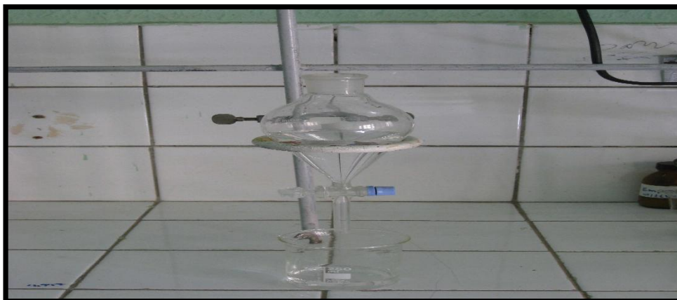
Figure 14 : Dispositif de décantation
