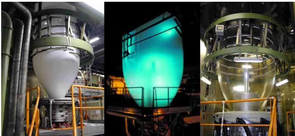
Figure II.9. La co -extrusion par gonflage de films tricouches
