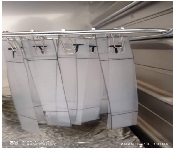
Figure III.4. Photographie des Films coupés en éprouvettes et mis en étuve.
