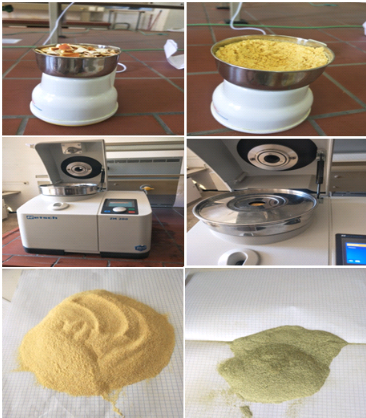
Figure 3.2 : Les étapes de broyage et les poudres obtenues.
