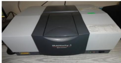
**Figure III.6 :** la spectroscopie infrarouge
