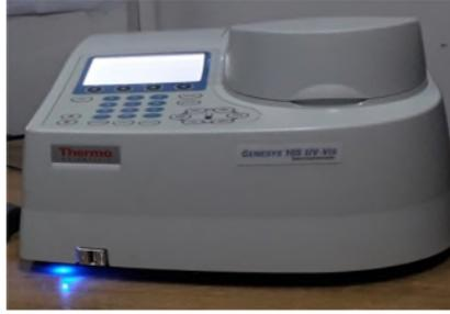
**Figure III.5 :** spectrophotomètre UV-visible
