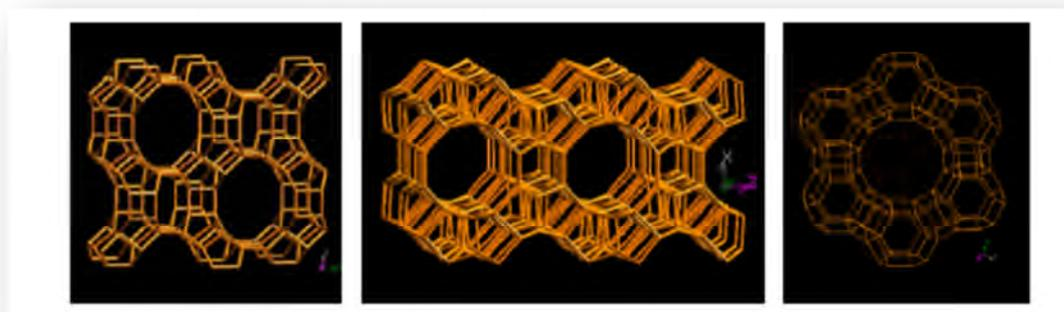
**Figure I.16** : Différents types de canaux des zéolites.[42]
