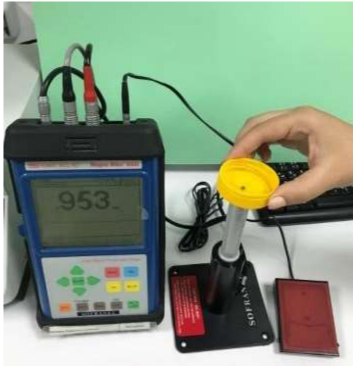
Figure 40 : Mesure de l'épaisseur de bouchon à l'aide de l'appareil mesures d'épaisseurs
