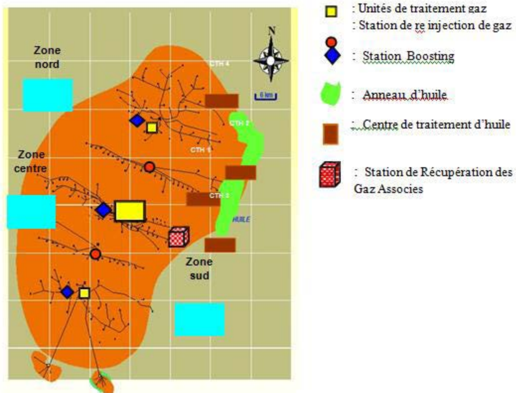
Figure II.1: Répartition des différentes installations sur le champ de Hassi R'Mel [10]
