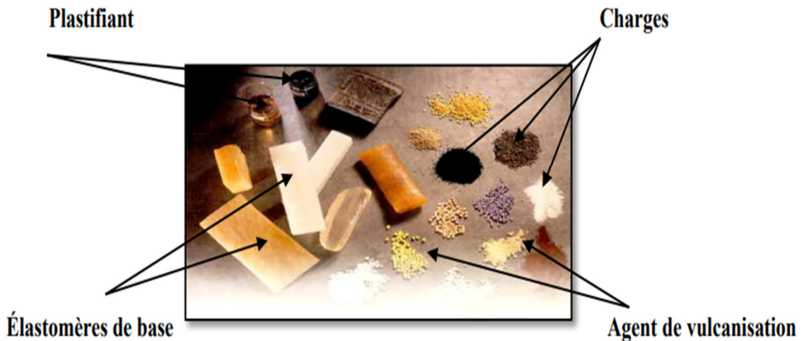
Figure 4 : Les matériaux qui rentrent dans la composition d'un pneu
