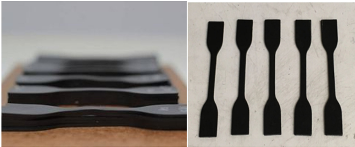
Figure 11 : Forme des éprouvettes haltères
