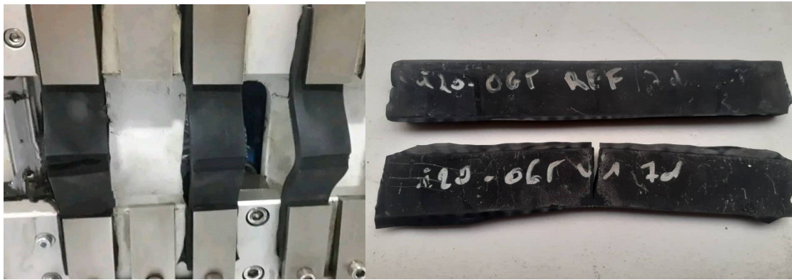
Figure 15 : Les éprouvettes après vieillissement à 90°C pendant 7 jours
