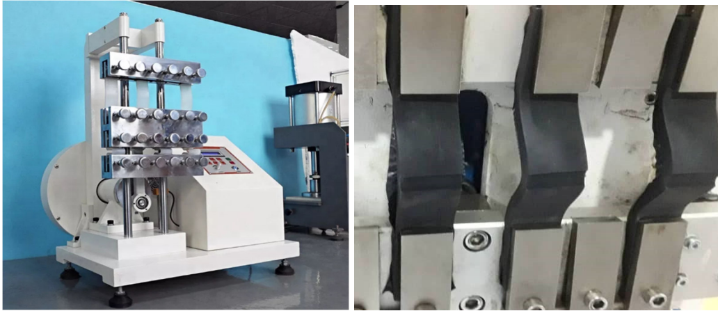
Figure 14 : Le tester « De mattia » et le montage des éprouvettes
