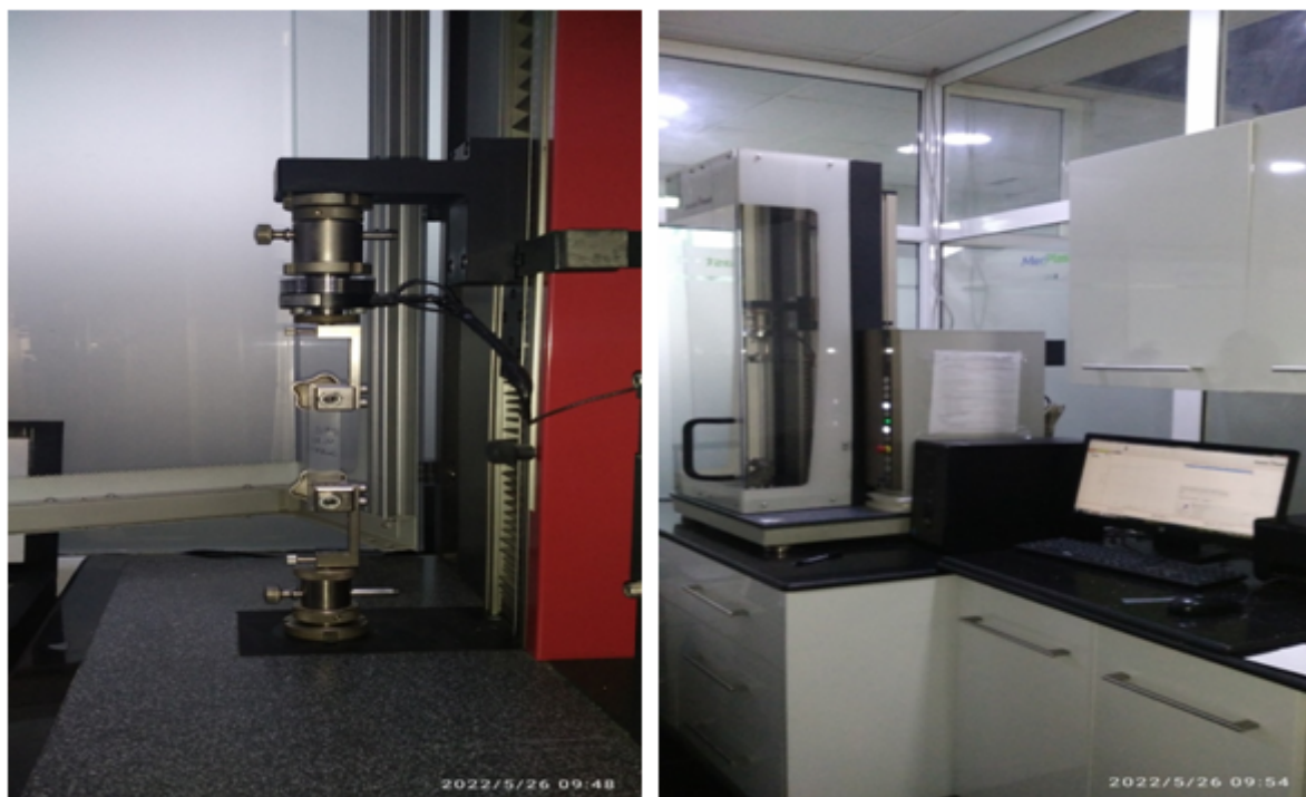
Figure 3.5 : Photographie de la machine de traction de marque Universal ZwickRoell avec testControl II
