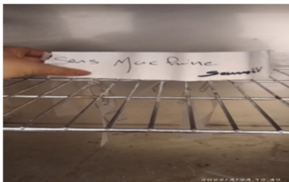
Figure 3.1 : Echantillons vierges du PEBD sans anti-UV dans l'étuve
