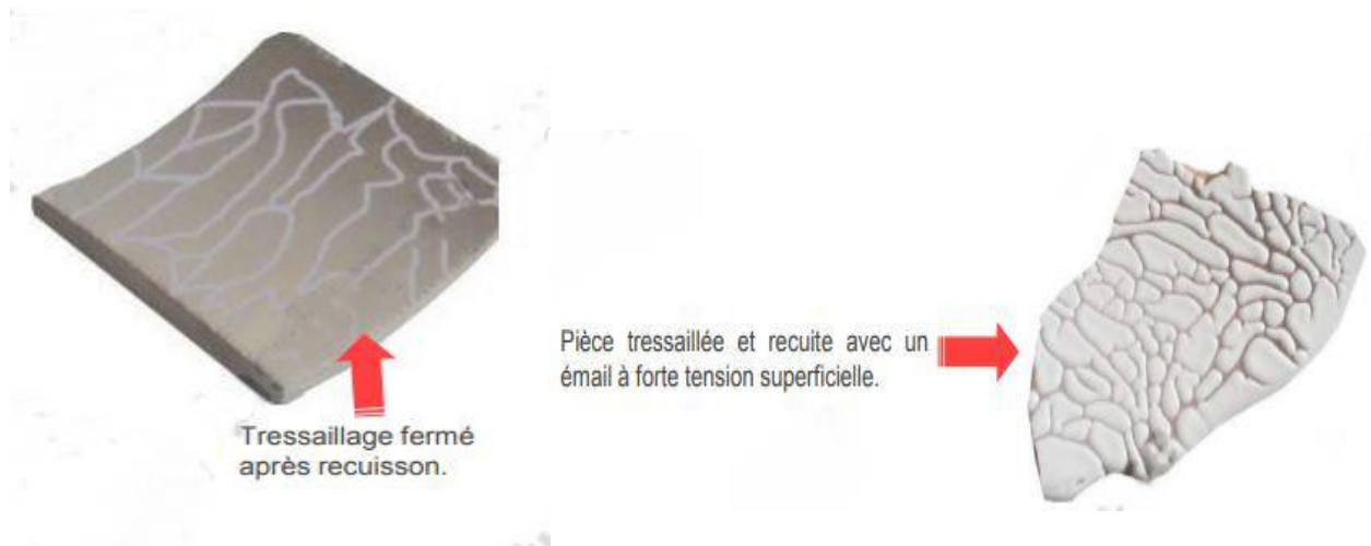
FigureV.7 Traissailage d'un carreau céramique
