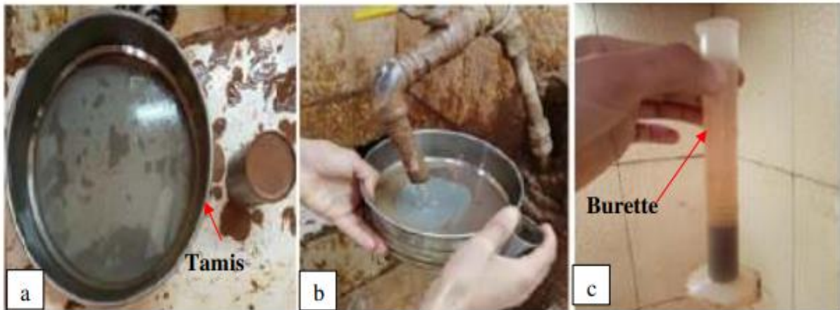
Figure IV.9 Étapes de mesure de refus : tamis (a) ; lavage de barbotine avec l'eau (b) ; lecture de valeur du refus sur une burette graduée (c)
