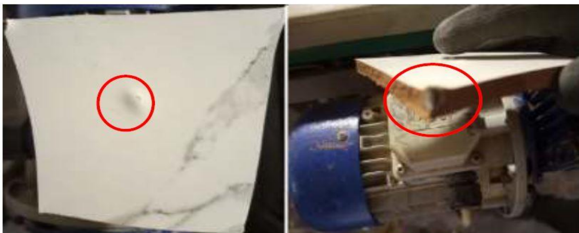
Figure V.5 Photos d'une bulle sur l'émail du carreau
