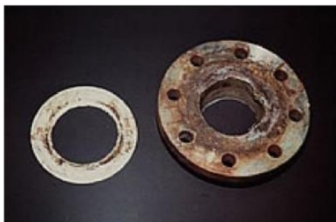
Figure I.4. Corrosion caverneuse d'un acier allié sous un joint.
