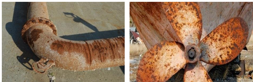
Figure I.2. Exemples de corrosion uniforme d'une pièce métallique.
