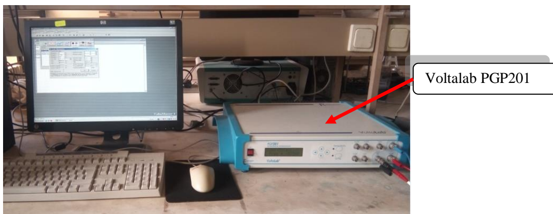
Figure II.8. Dispositif électrochimique de type PGP201
