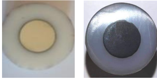
Figure III.7. Images montrant la surface de l'acier avant et après dépôt de film de Ppy dans la solution C_2H_2O_4 (0.2M). Temps de synthèse = 60 min. C_{py} = 0.1M . i_{imposée} = 1.5 \text{ mA/cm}^2 .
