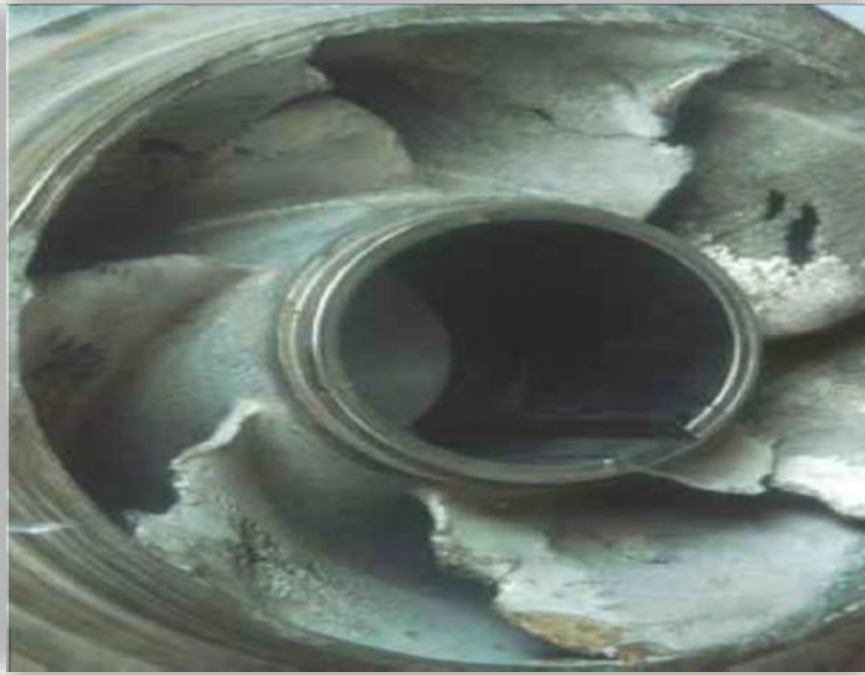
Figure (V.7) : Phénomène de cavitation sur des aubes d'une pompe centrifuge.
