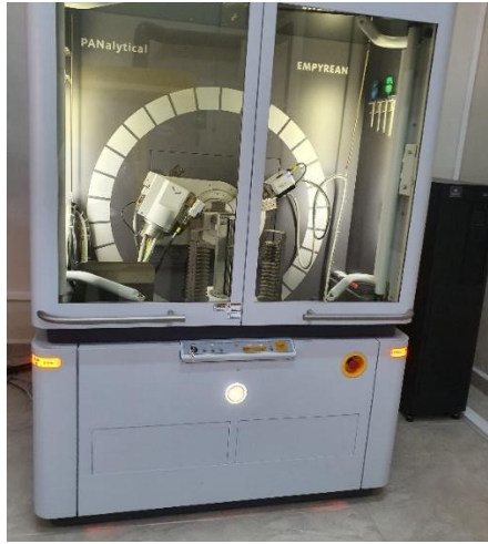
Figure II.6. Analyses de matériaux par diffraction des Rayon X.
