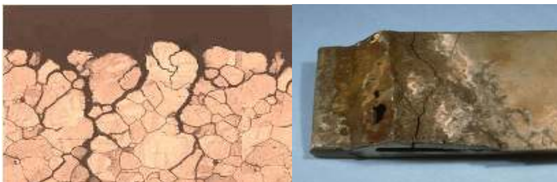
Figure I.8 : Corrosion sous contrainte [34].
