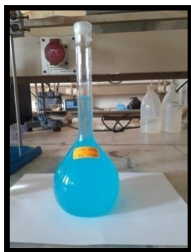
Figure II.6 : Solution électrolytique composée de 0.2 M d'acétate de sodium ( \text{C}_2\text{H}_3\text{O}_2\text{Na} ) et 0.01 M d'acétate de cuivre ( \text{Cu}(\text{CH}_3\text{COO})_2 ).
