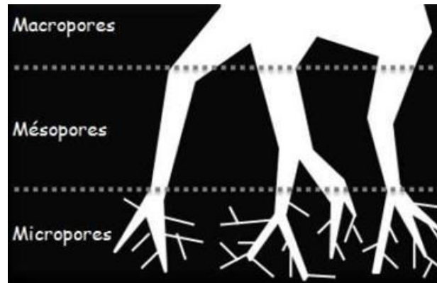
Figure I.2 : Structure interne du charbon actif
