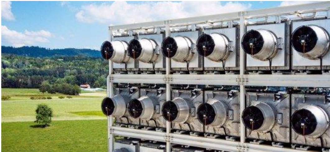
Figure II.17 : Installation de captage direct de CO 2 dans l'air à Hinwil dans le canton de Zurich. (©Climeworks). [25]
