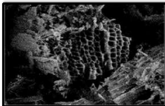
Figure I. 8 : Structure du charbon actif vu sous un microscope électronique [27].
