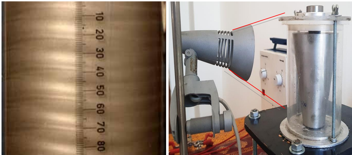
Fig. III.7 : Visualisation d'un état d'écoulement par réflexion optique.
