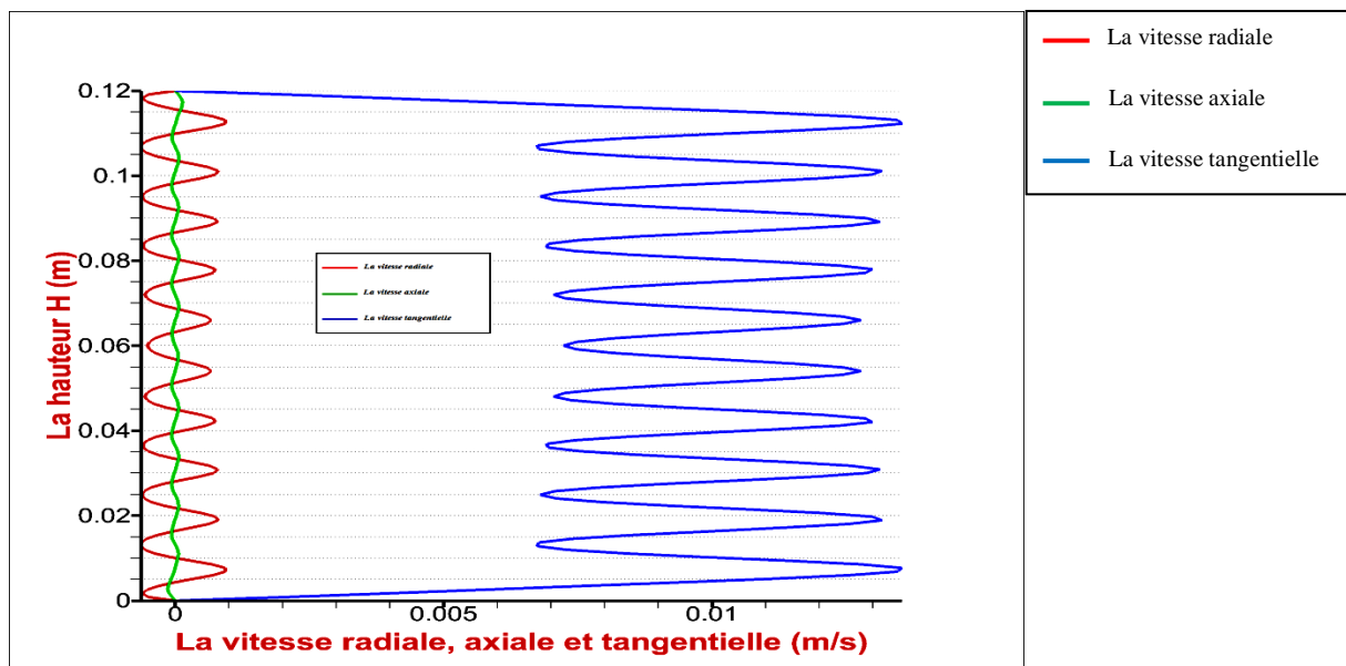
Fig. VI.6 : les profils des vitesses le long de l'espace annulaire, Ta=44 et \Omega_I=4.48 tr/mn .
