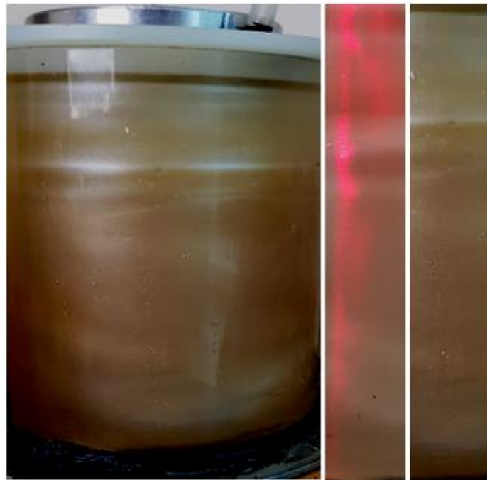
Fig. IV.9 : Visualisation de l'effet de l'angle de conicité pour \alpha=12^\circ à Ta=T_{c1} et \Omega_l=\Omega_{c1} .
