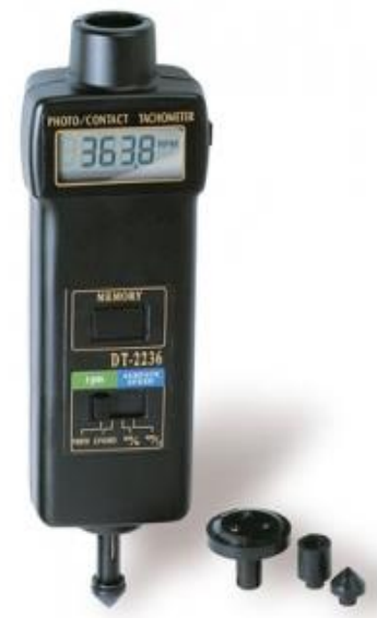
Fig. III.4 : tachymètre digital DT 2236 (Compte-tours portable).
