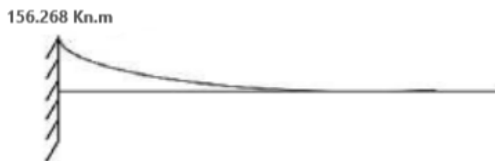
Figure 4.12 : Diagramme du moment fléchissant du support de chemin de roulement.
