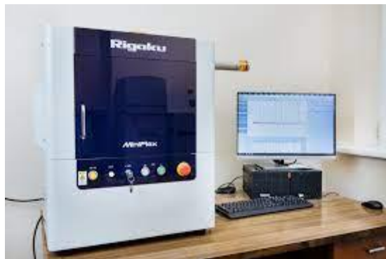
Figure III.5: appareil utilisé pour l'analyse DRX
