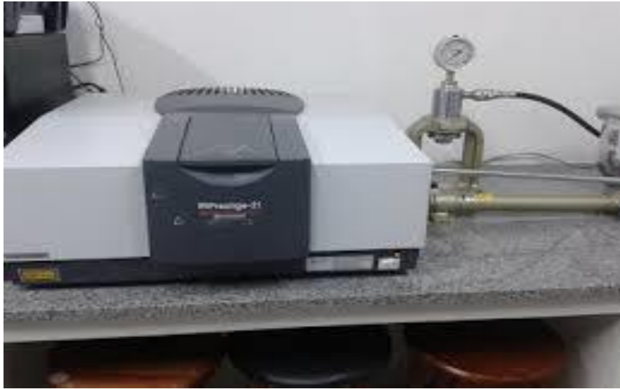
Figure III.4 : l'appareil utilisé pour analyse FTIR
