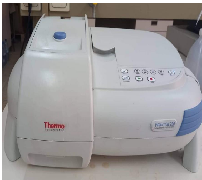
Figure III.8: Image du spectroscope UV-visible solide utilisé.
