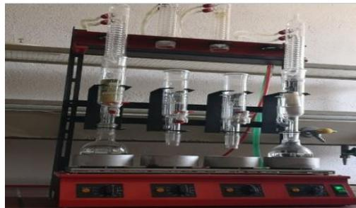
**Figure IV.6:**Présentation d'appareil d'extraction par la méthode de soxhlet.
