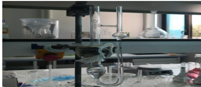
**Figure IV.7:**Viscosimètre d'Oswald
