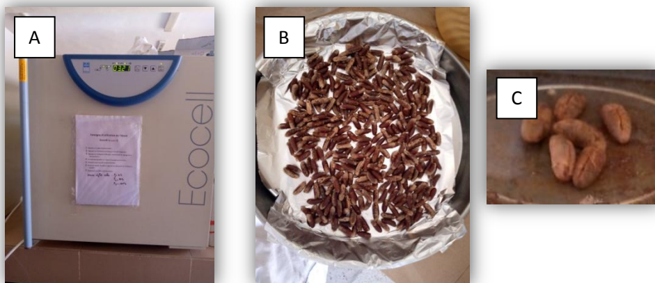
Figure 09 : Détermination de la matière sèche. A : Etuve ventilée ; B : noyaux ; C : 5g de noyau.
