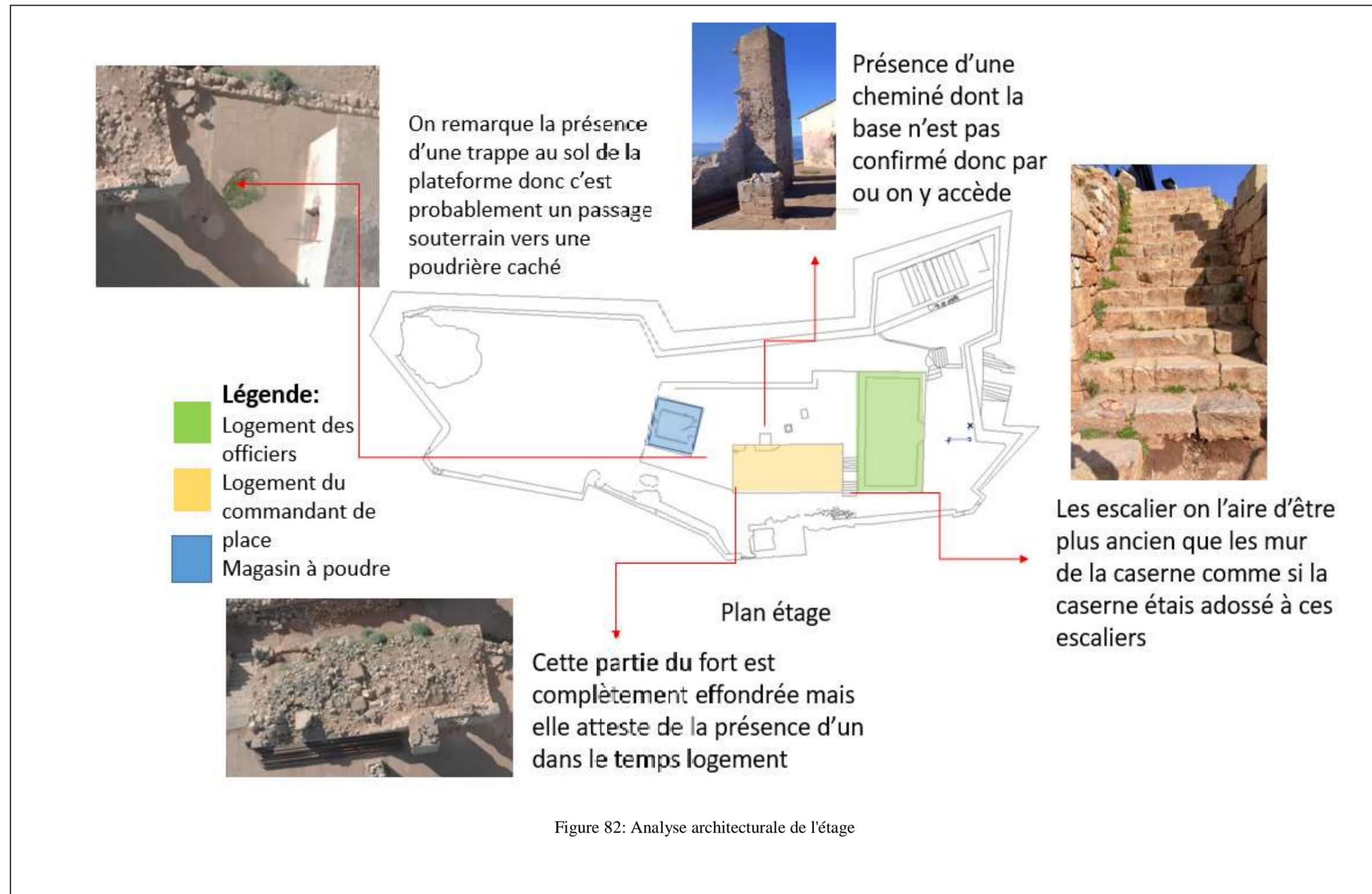
Figure 82: Analyse architecturale de l'étage
