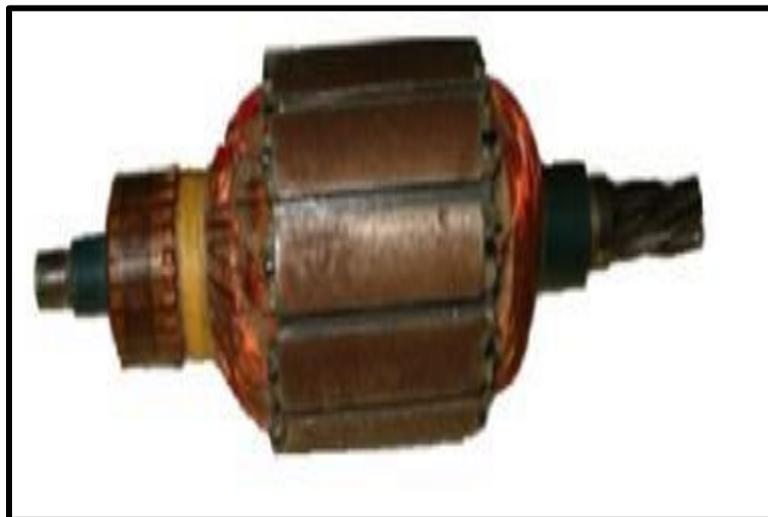
Figure I. 3: Rotor (induit) de Moteur
