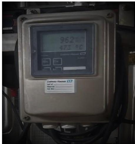
Figure 14 : Image d'un conductimètre
