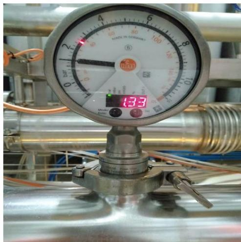
Figure 12 : Image d'un capteur de niveau analogique
