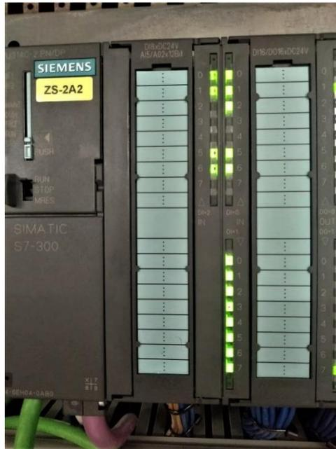
Figure 23 : Automate programmable industriel S7-300
