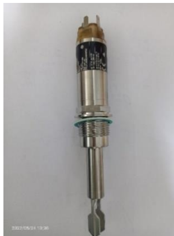
Figure I-15 : Capteurs à lame vibrante de type FTL31.
