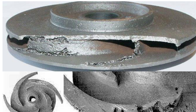
Figure IV.4 : Dégât de cavitation sur une pompe
