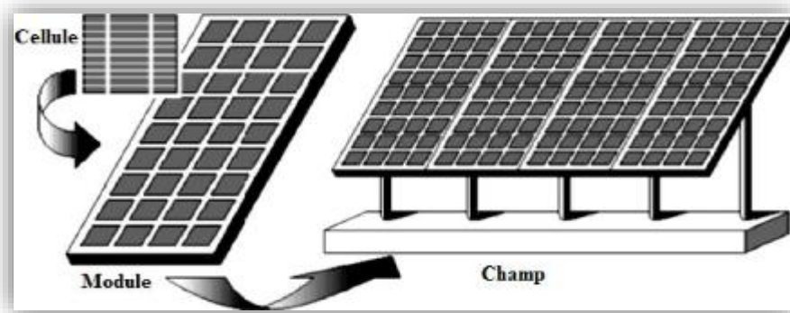
Figure II.12 : Cellules, modules et champ panneaux photovoltaïques
