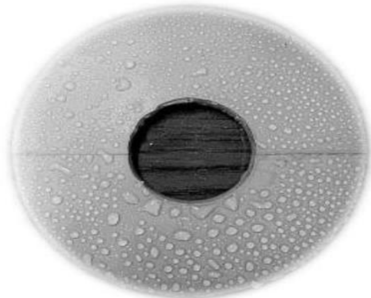
Fig.15 : Surface d'une ailette découpée à partir d'une chaîne d'isolateurs composites en silicone et recouverte de gouttelettes d'eau.
