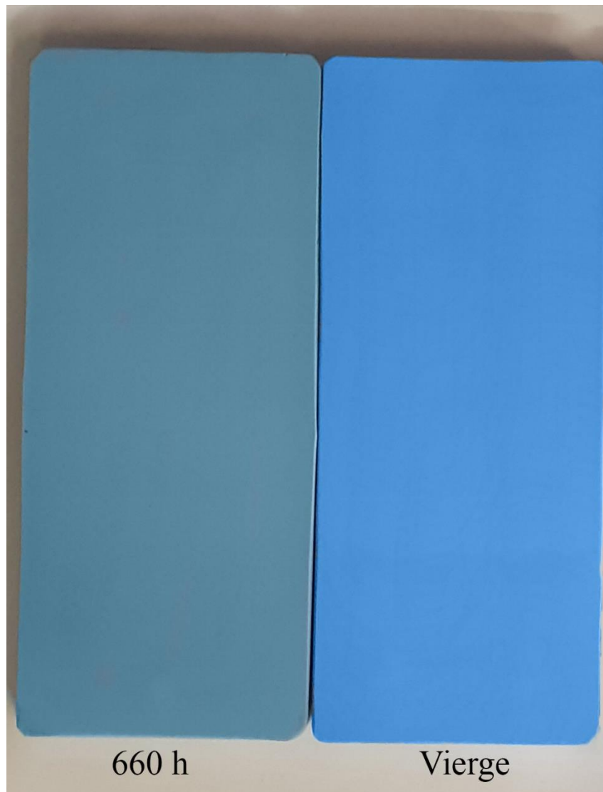
Fig.41 : Différence de couleur entre l'échantillon vierge et l'échantillon qui a subi 660h de vieillissement au UV
