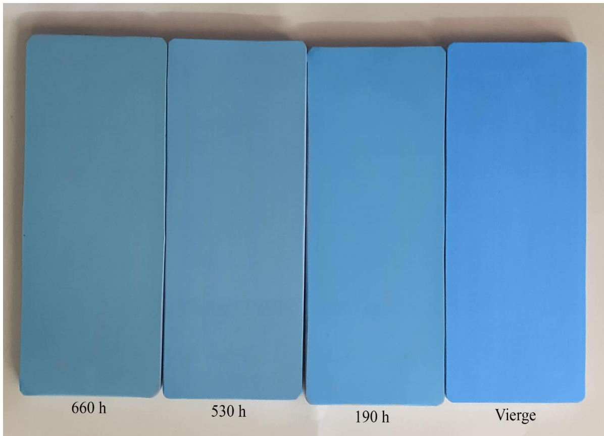
Fig.40 : Observation visuelle de la décoloration des échantillons en silicone après vieillissement UV
