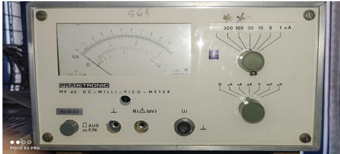
Figure II.10 : Pico-ampèremètre à aiguille utilisé dans la mesure du courant de la sonde
