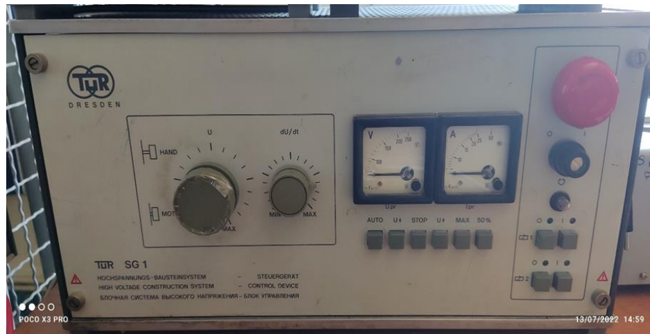
Figure II.6 : Photo de la source basse tension SG1
