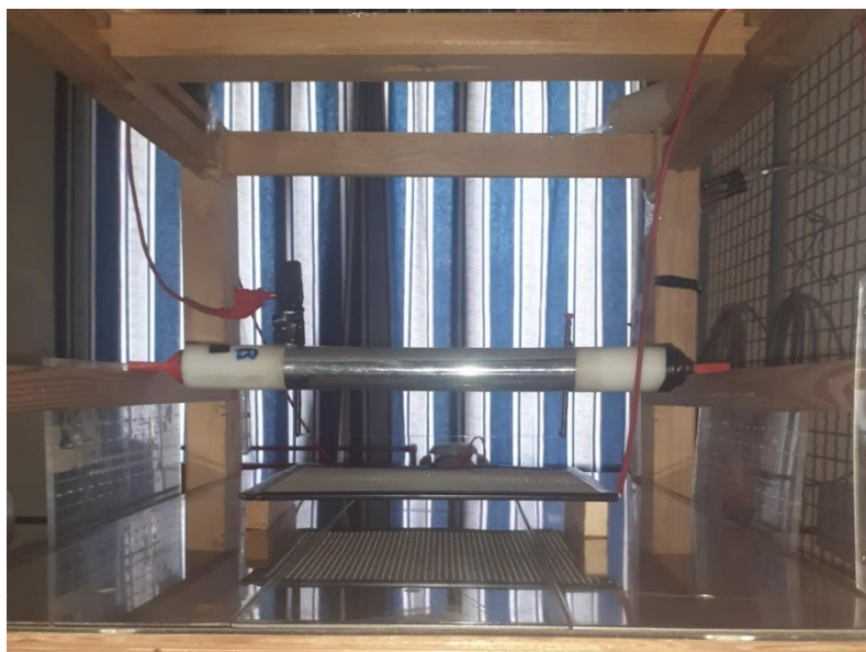
Figure II. 11 : Décharge couronne dans le système triode
