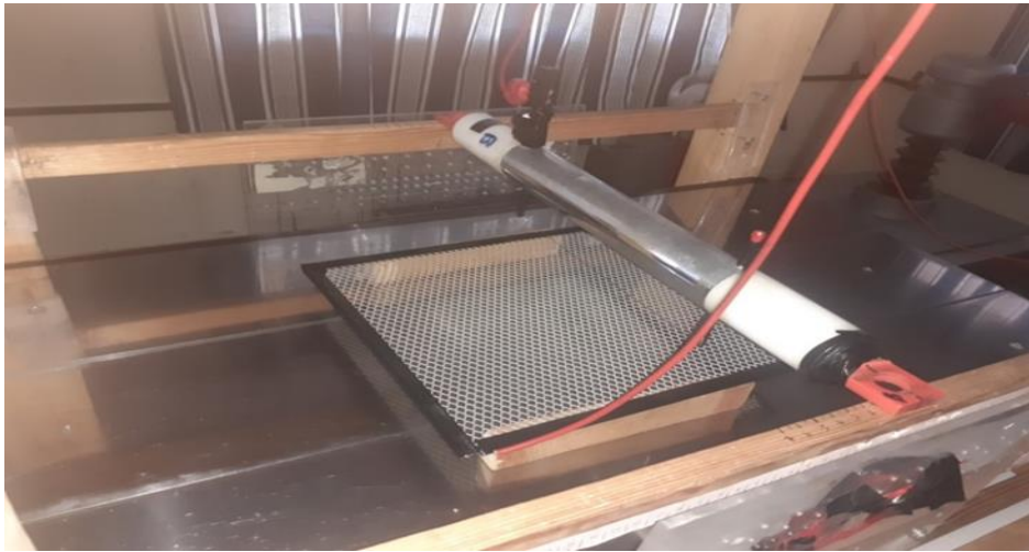
Figure II. 12 : Vue de côté de la configuration triode
