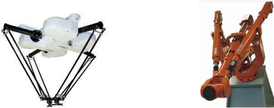
Figure.I.6 : Bras manipulateurs parallèles
