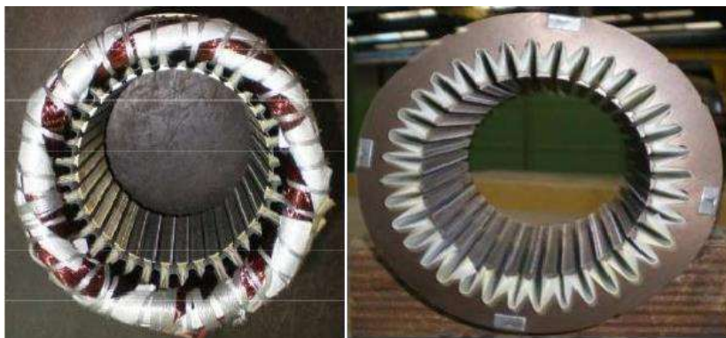
Figure II.10 : Stator avec bobinage. Figure II.11 : Stator sans bobinage.
