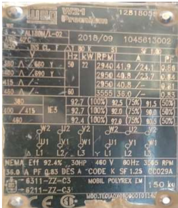
Figure II.18 : Plaque signalétique du moteur Weg21.
