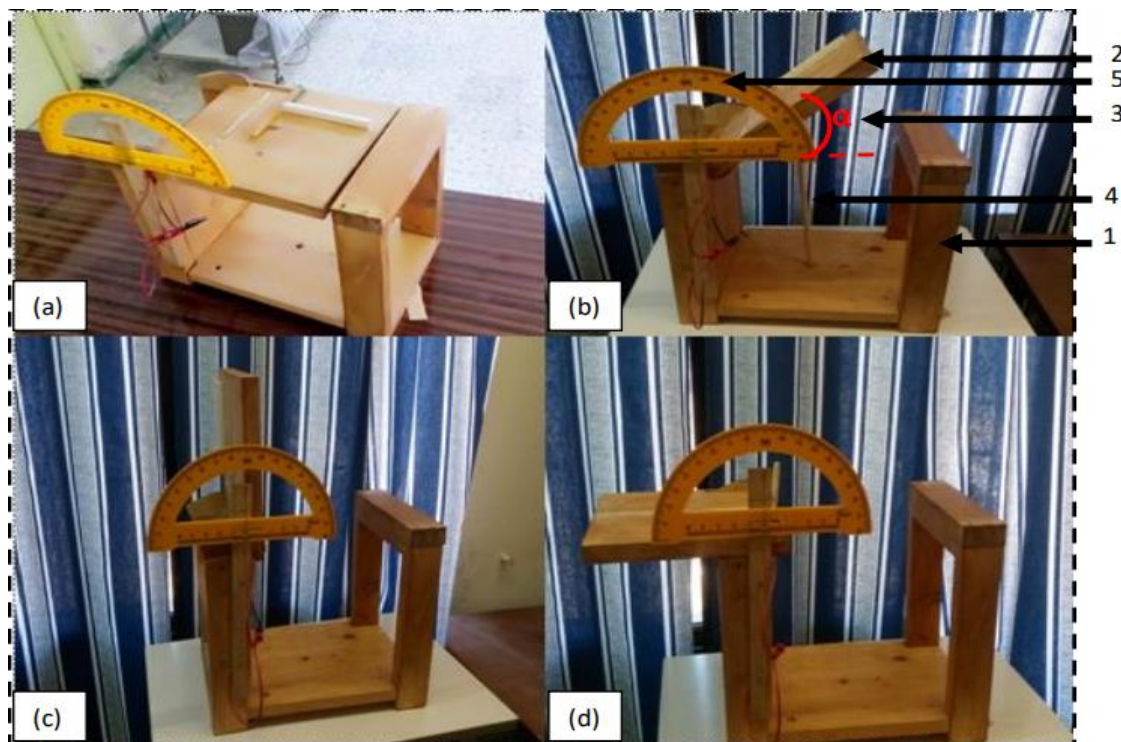
Figure III.6 : Différentes vues du banc d'essai de mesure de l'angle de contact \theta .
