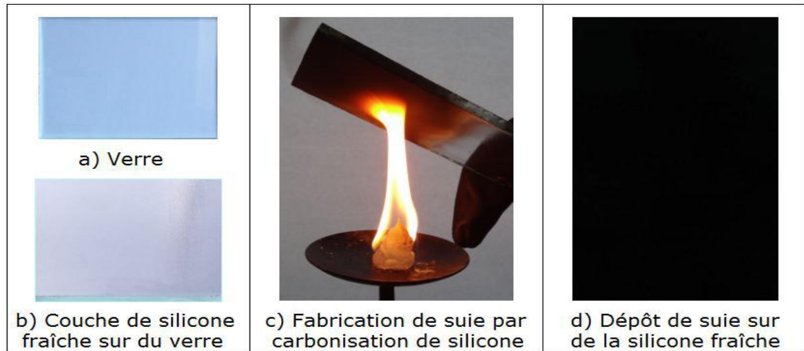
Figure III.5 : Etapes essentielles de confection d'une surface en verre superhydrophobe.
