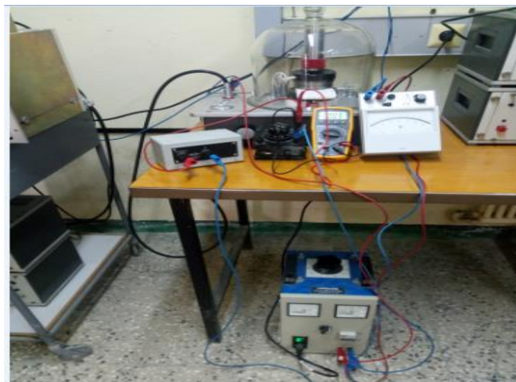
Figure III.15: Photo du dispositif de mesure des résistances R_t et R_s .
