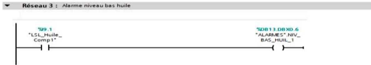
**Figure III-23** Alarme défaut niveau bas de l'huile dans le 1er compresseur
