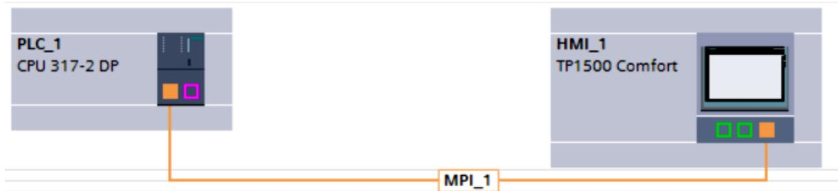
Figure IV-2 Liaison MPI établie entre CPU et IHM
