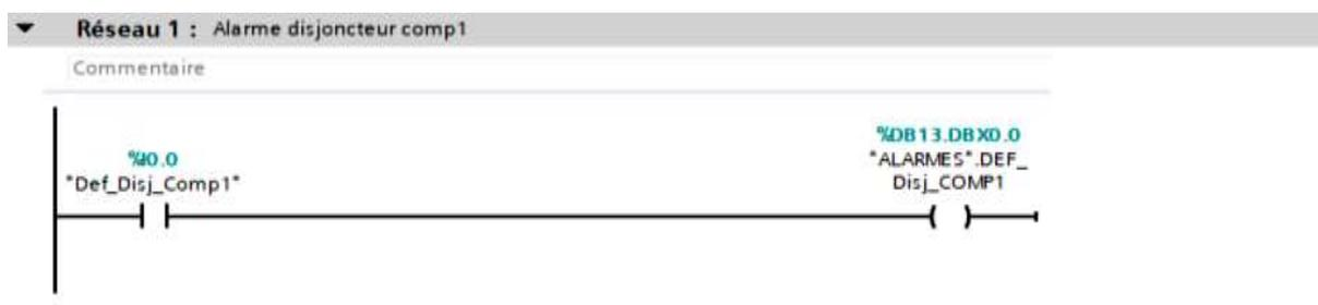
*Figure III-22 Alarme défaut disjoncteur du 1er compresseur*
