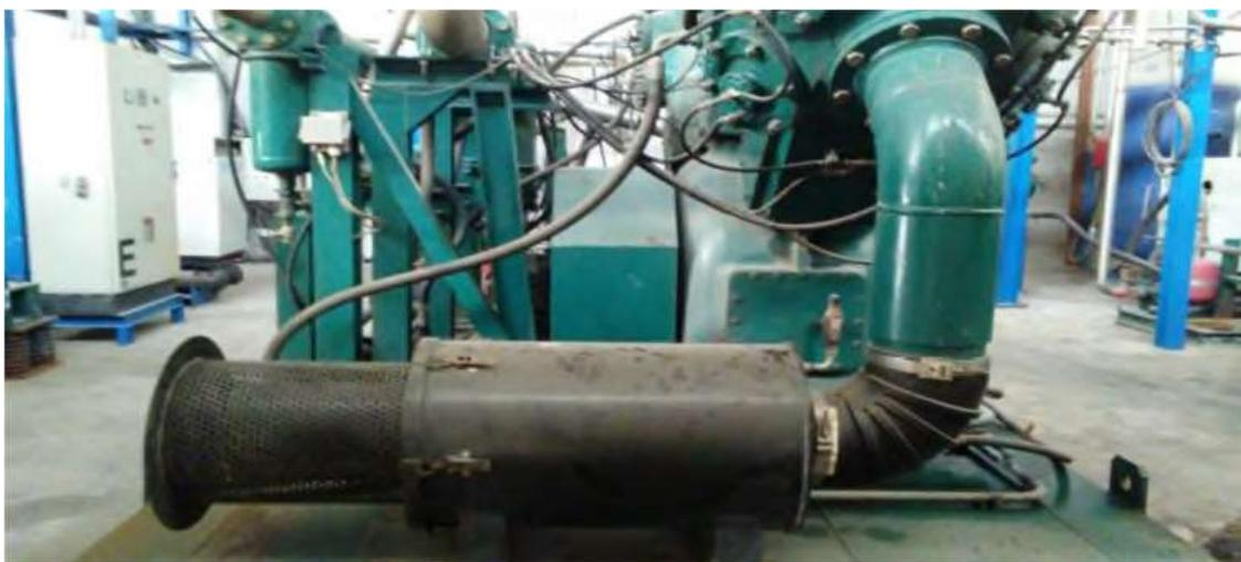
*Figure I-11* Filtre à air
