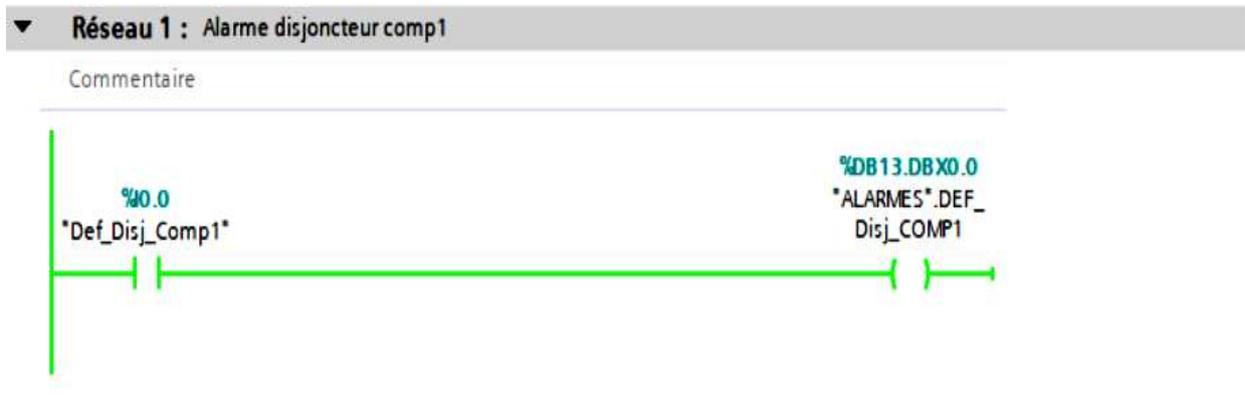
Figure IV-21 Alarme lors d'un défaut disjoncteur de 1ier compresseur.
