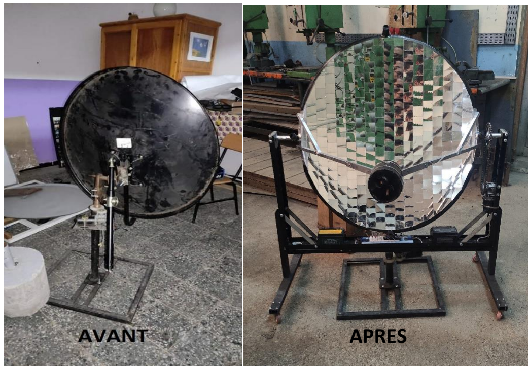
Figure IV.1 Le concentrateur avant et après les modifications
