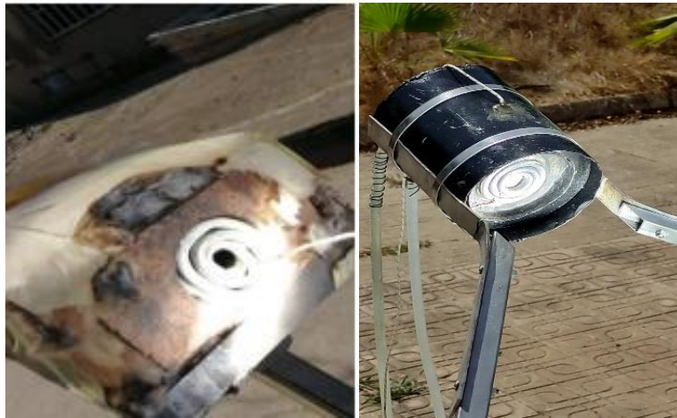
Figure IV.2 L'absorbeur avant et après les modifications
