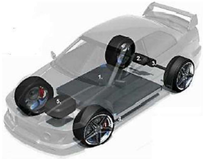
Figure I. 1: Le système de propulsion électrique
