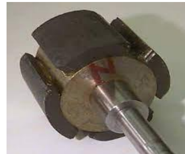
c) - Rotor à aimants permanents
