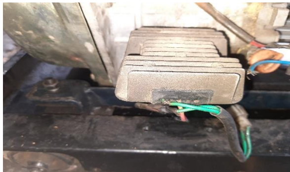
Fig.I.19 - Chargeur de batterie
