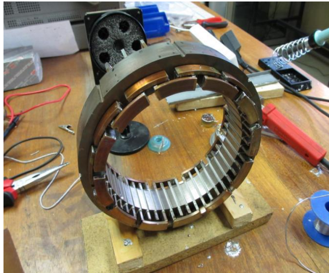
Figure I.2. Stator d'une MAS.[8]
