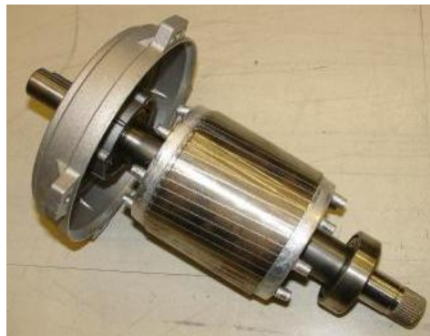
Figure I.4. Rotor à cage.[10]
