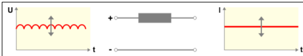
Figure I.14. Circuit intermédiaire à courant continu variable
