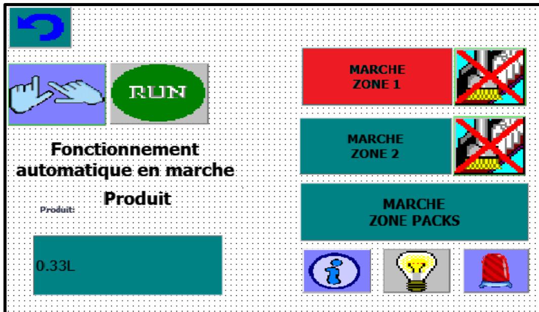
Figure III.27 : Démarrage de la zone 1
