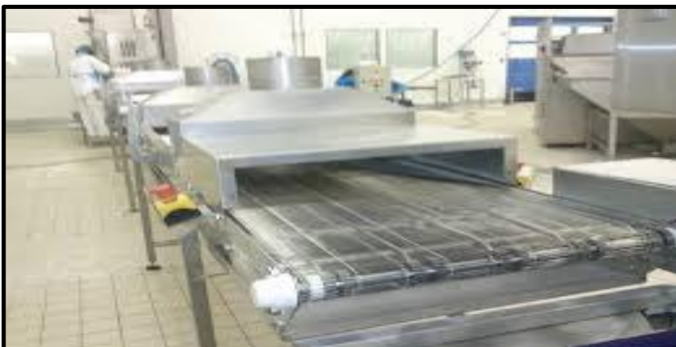
Figure I.8 : Convoyeur à maille inox
