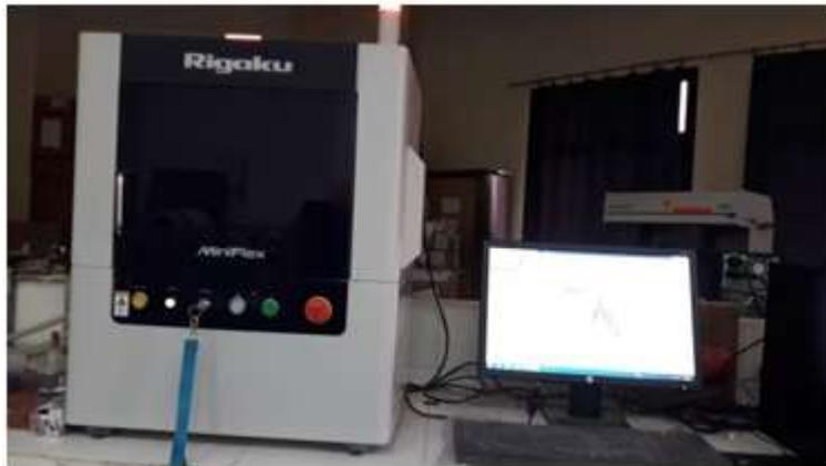
*Figure III.9: Diffractométrie a rayon X de type Rigaku Mini flex-II diffractometer (Laboratoire de physique des matériaux et catalyse, Université de Bejaia)*
