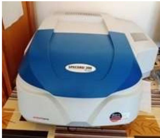
*Figure III.12 : Spectrophotométrie UV-Visible*
