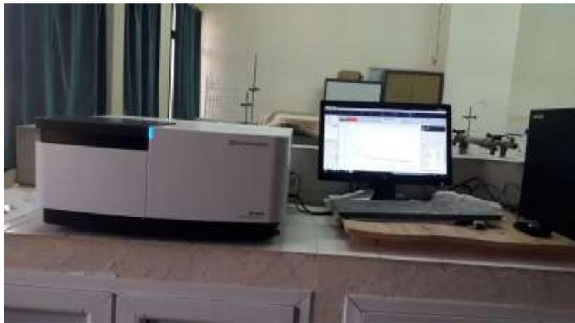
*Figure III.17 : Spectromètre de la photoluminescence*
