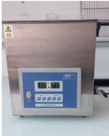
*Figure III.2: Appareil de nettoyage d'ultrason*
