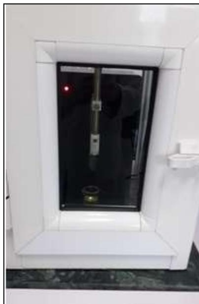
*Figure III.5 : Appareillage de dip-coating*
