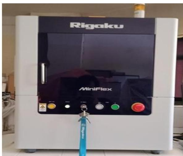
**Figure III.5** : Diffractomètre Miniflex Rigaku.
