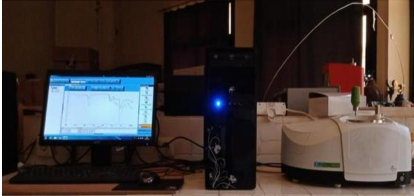
**Figure III.6 :** Spectromètre L160000A de la marque Perkin Elmer.
