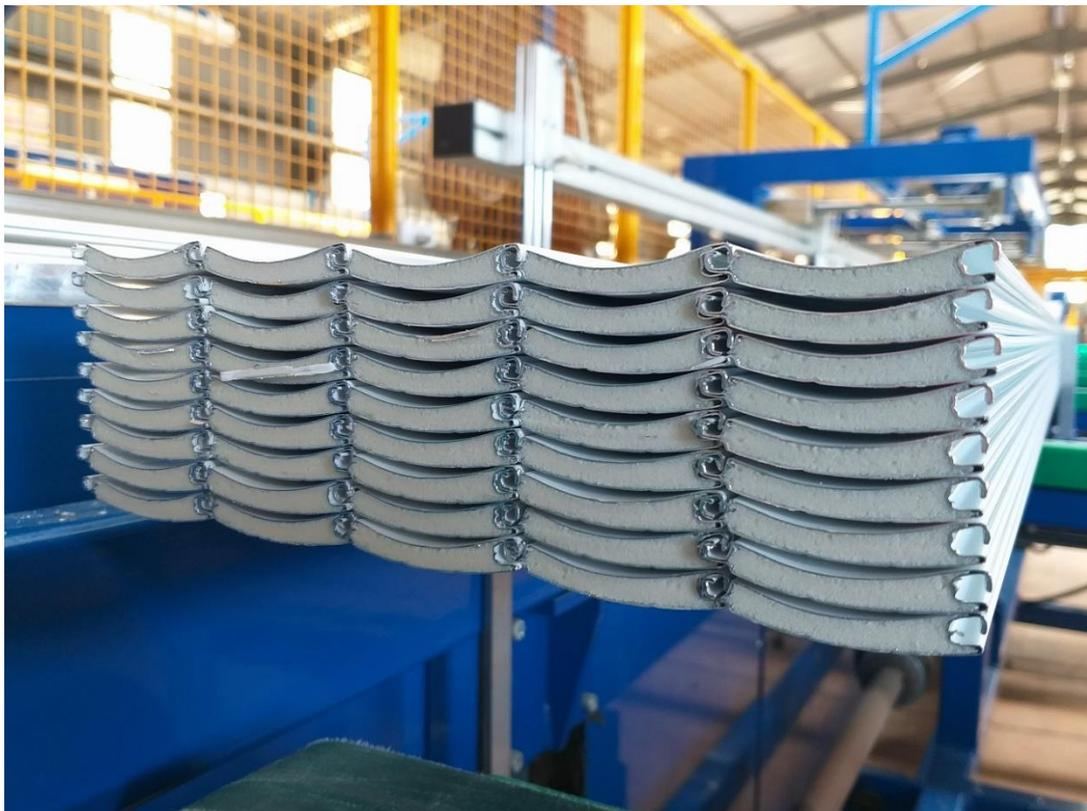
Figure 1.3 Lame thermique pour volets roulants
