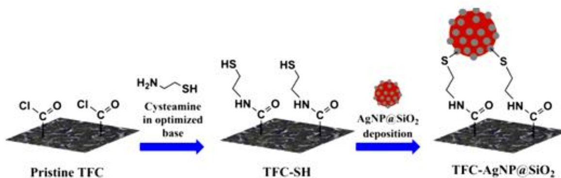
Figure I.10. Illustration schématique de la fixation des nanoparticules Ag/SiO 2 sur une surface membranaire en polyamide par greffage chimique [147].
