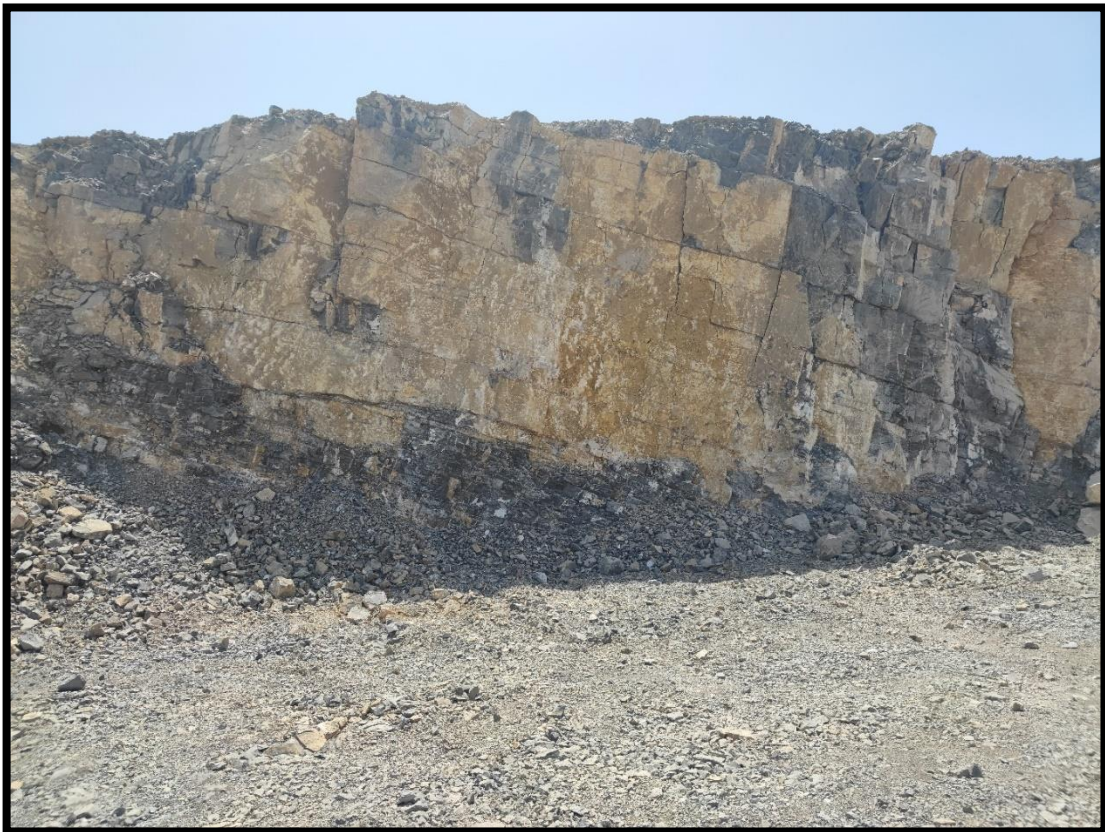
Figure II 1 : Structure géométrique d'un massif rocheux de calcaire de la cimenterie d'Ain El-Kbira
