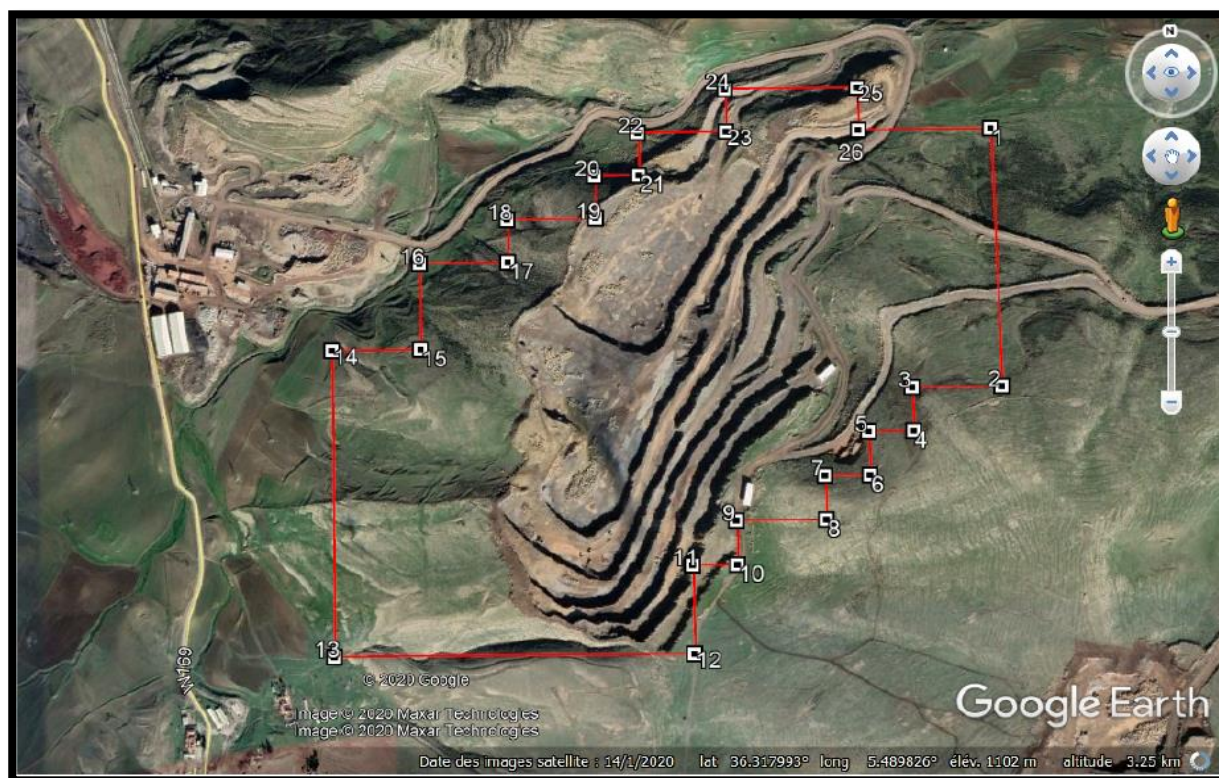
Figure I.2: Image satellite du périmètre de permis d'exploitation de la carrière de calcaire {Djebel medjounès} - (Google Earth)
