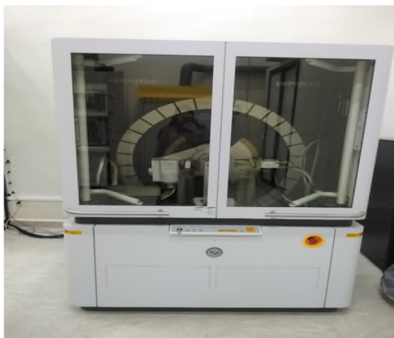
Figure II.7. Appareil de la diffraction des rayons X (DRX).
