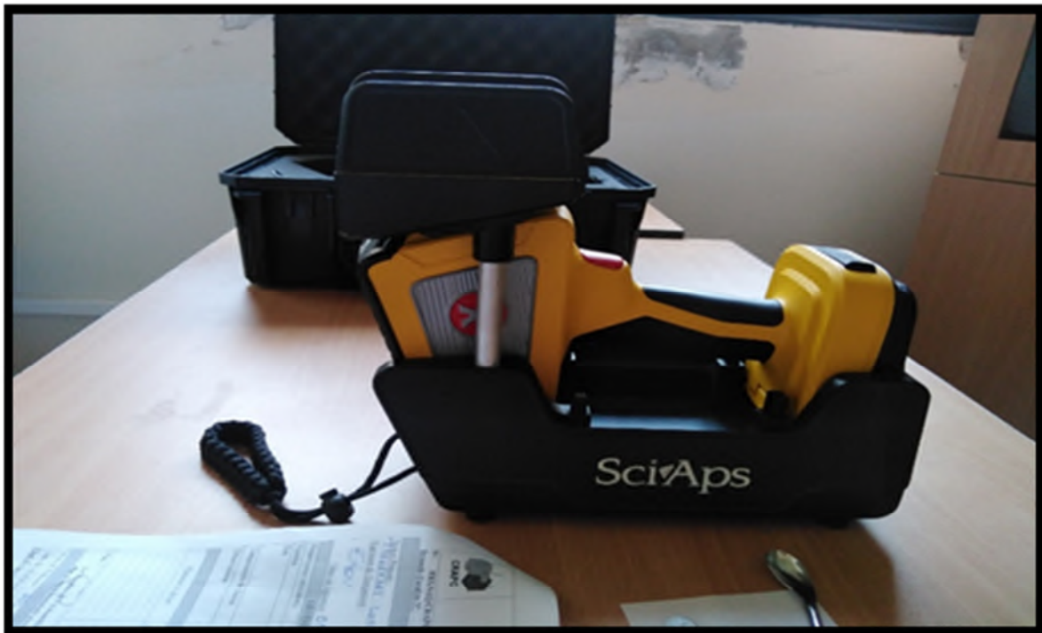
Figure II.8. Analyseur par fluorescence X portable.
