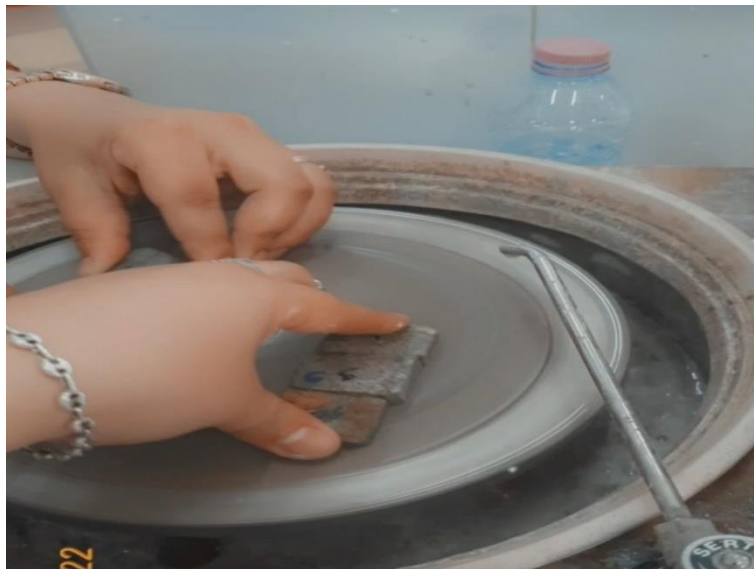
Figure II.07 : Polissage des sucres sur la machine à rodage (photo prise)
