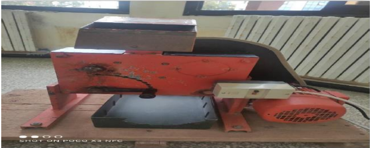
Figure II.08 : Concasseur à mâchoire pédagogique (photo prise)
