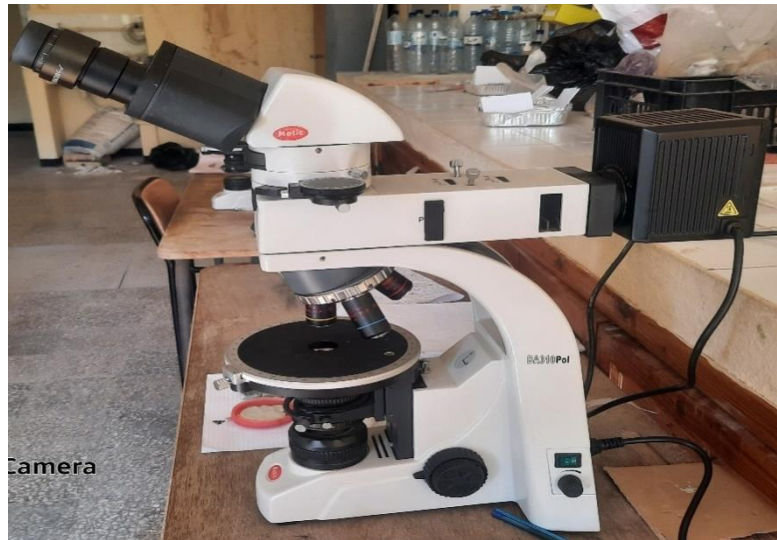
Figure III.13 : Le microscope pétrographique.
