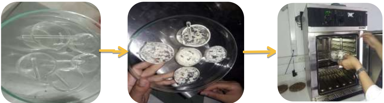
Figure 12 : Les étapes de détermination de l'extrait sec total
