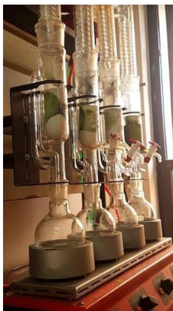
Figure 9 : Photographie originale de l'extraction par Soxhlet.
